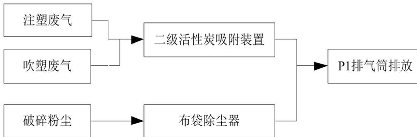
图 2-5 废气处理流程图
